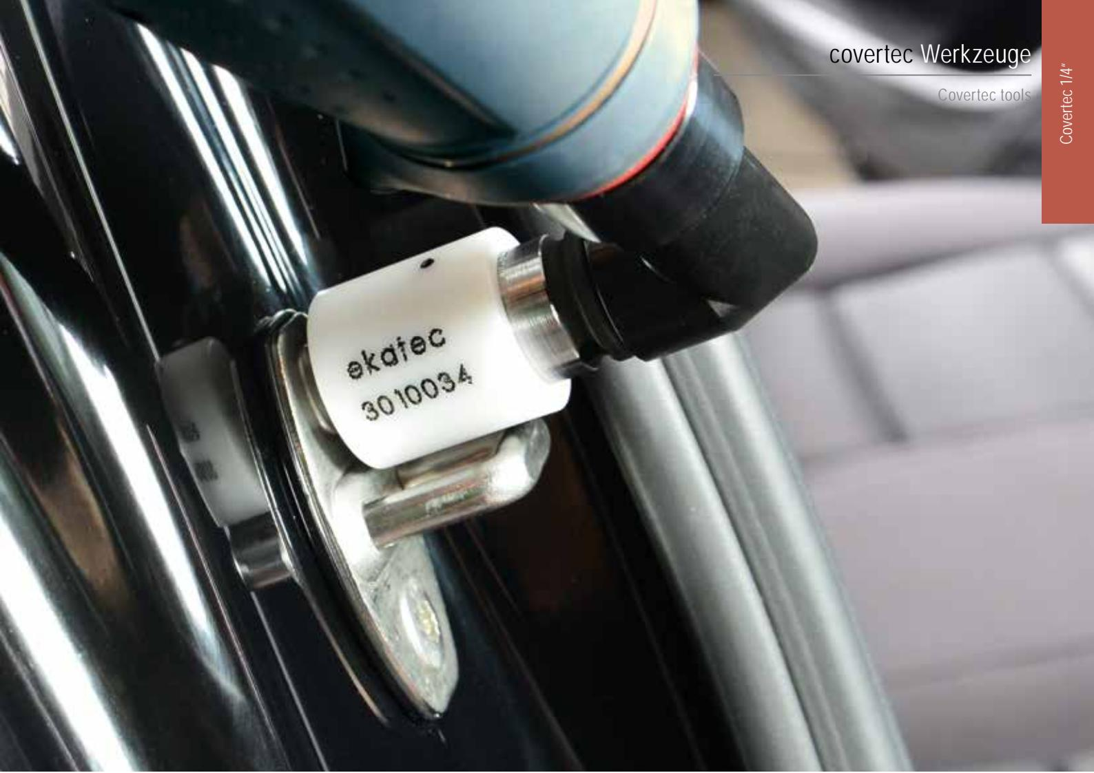
Steckschlüssel 6-kant dünnwandig, Pinch-point
