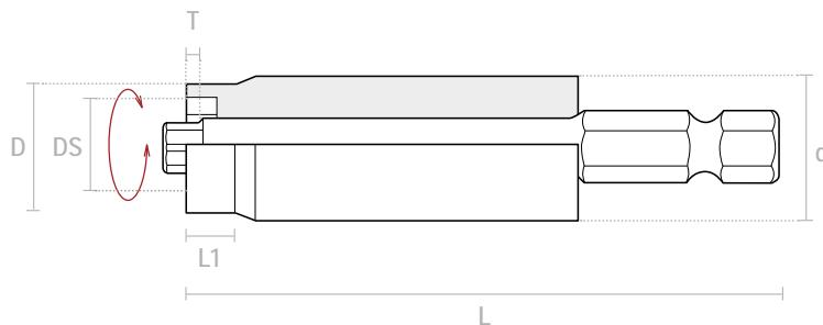
Covertec Bit drehbare Hülse mit Magnet, Torx
